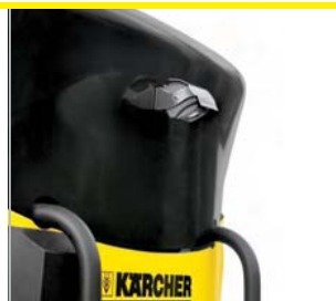
Kamera snímající prostor vzadu s monitorem v kabině zvyšuje bezpečnost při jízdě dozadu.
